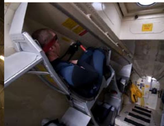
Ingesnoerd De binnenkant van de vrije-valboot, volledig in de gordels in een stoel.
